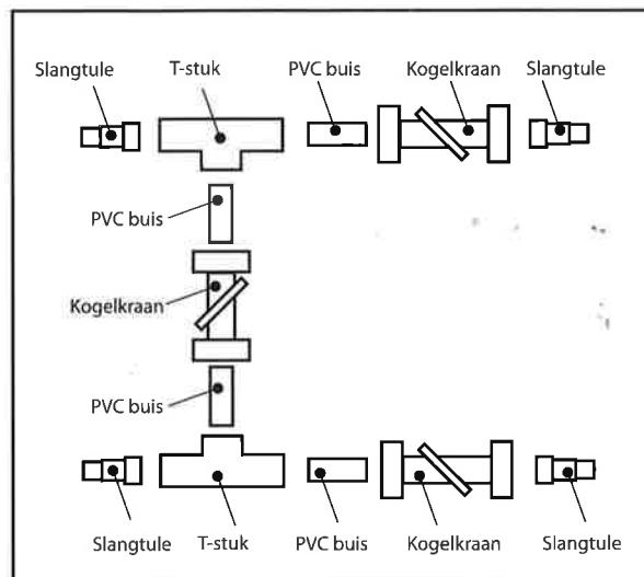
3. Sluit de slangen van uw pomp/filter, warmtepomp en zwembad aan volgens onderstaand schema
